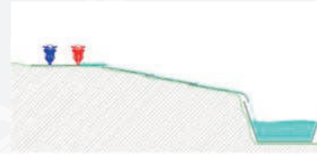
Figura 59: Realizzazione di zone per lavaggio moto in paddock provvisori.
