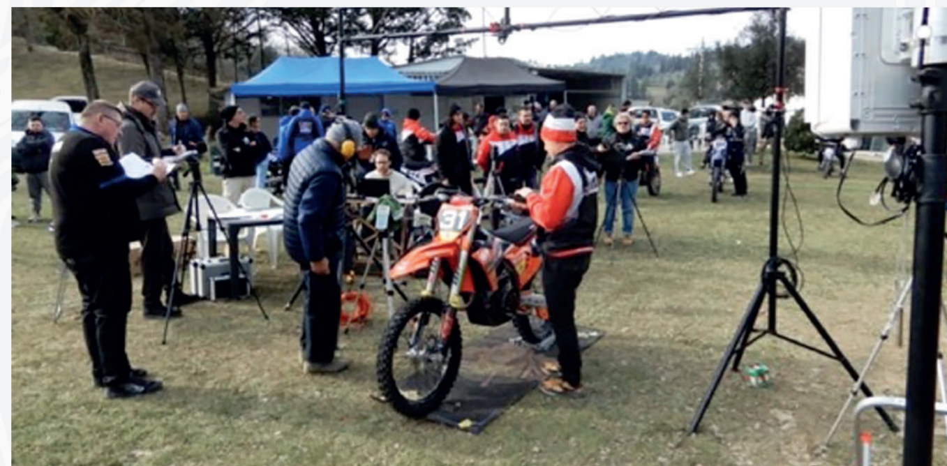
Figura 39: Postazione misure fonometriche per determinazione potenza sonora moto da cross.
